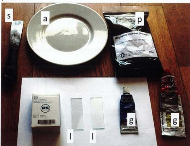
Figure 6 : Matériel nécessaire pour la préparation de la pâte magnétique
