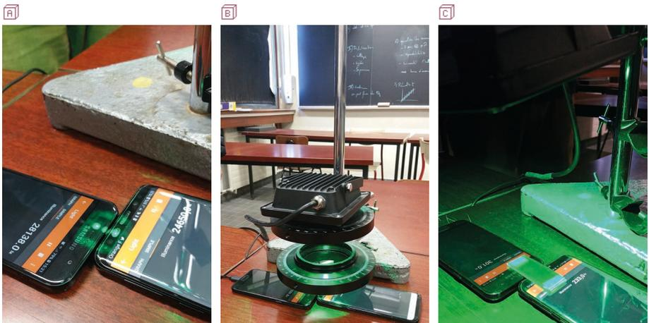
**Figure 1** - **A**) Image des LEDs vertes de la source sur les capteurs de lumière des smartphones ; **B**) Polariseur et analyseur pour l'étude de la linéarité des capteurs ; **C**) Transparents verts sur les capteurs, éclairage en lumière verte.
